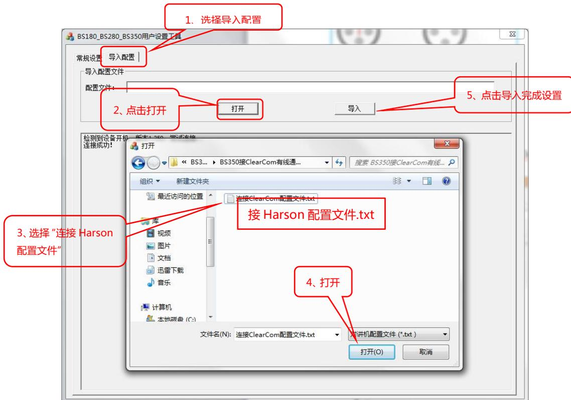
2、配置导入完成后，断开数据线，重启开机，配置完成。
