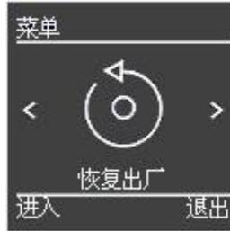
将所有参数恢复成出厂默认参数。选择“恢复出厂设置”按退出按键，所有参数恢复出厂默认参数。
