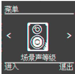
手持机在发送语音信号的过程中会将人声和环境声一起发给其他的接收设备，使用场景设置可以对语音发送过程中的环境声进行一定等级的抑制。出厂默认设置为 0。通过设置按键设置相应等级。（注：一般情况下无需更改此设置。如果等级设置太高易出现说话断续。）
