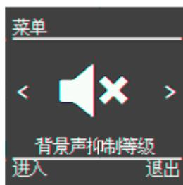
背景声抑制等级分为 6 个等级，等级 0 时，不进行任何的背景声抑制。等级 1-5，分别对背景声抑制 1%-5%。手持机在发送语音信号的过程中会将人声和环境声一起发给其他的接收设备，背景声抑制设置可以对环境声进行一定等级的抑制。出厂默认抑制等级为 2。通过设置按键设置相应等级。
