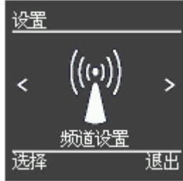
进入设置页面，可根据需要设置合适的信道，按右侧退出键退出完成设置。
